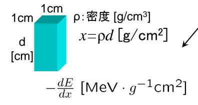
荷電粒子が物質を通過する際のエネルギー損失-dE/dx(=物質に落とすエネルギー)は, µ粒子の場合~300MeV/cで最小. それ以上の運動量を持つ粒子では, ゆっくり上昇(あまり変わらない).
