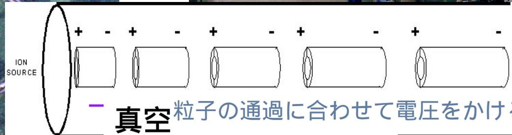
真空 粒子の通過に合わせて電圧をかける
