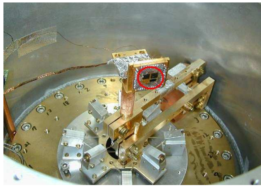
図 4.10: サンプルの配置 ADR の detector stage を撮影した。 赤丸内にサンプルが3つ配置されている。
