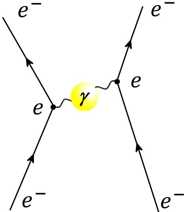
素粒子の観点でも，荷電粒子の作るカレント ( $j^\mu$ ) が光子（電磁場  $A_\mu$  を量子化した粒子）の源 (source) であり，同時に荷電粒子のカレントに働く力 (force) である。
