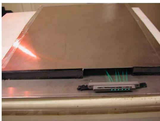
図 7.3 : CPR2 検出器の試作機 . 端部での透明ファイバーへの変換コネクタが見える .
