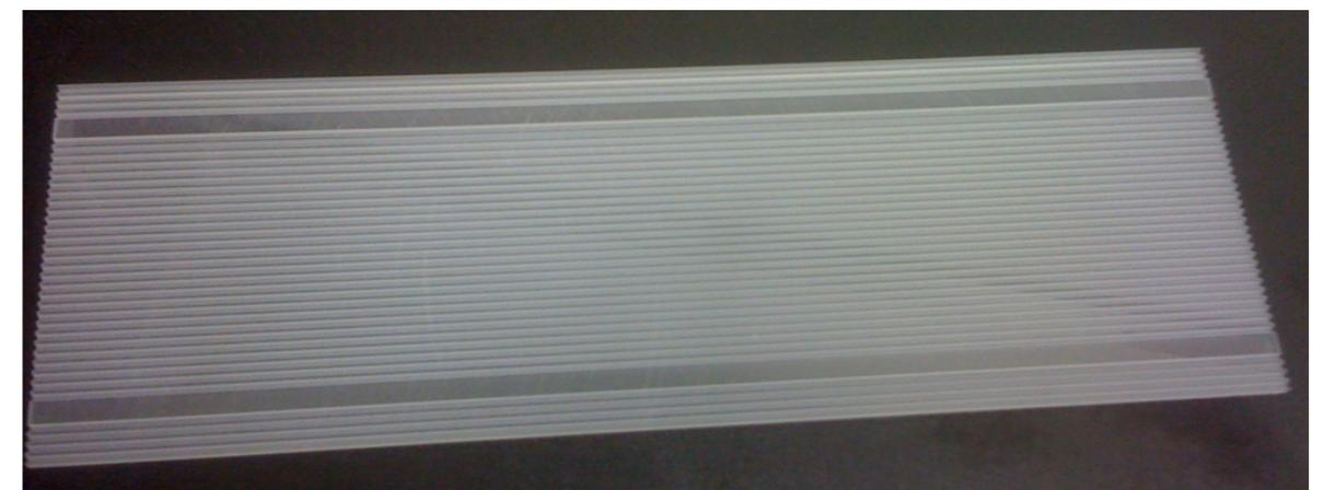
溝を切ったアクリル板 (2t, 溝径:  $\phi 1.1$ )
