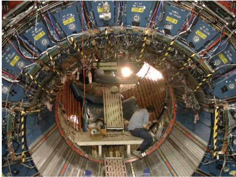
図 7: CDF 検出器のソレノイド磁石の内壁に TOF 検出器を設置している様子.
