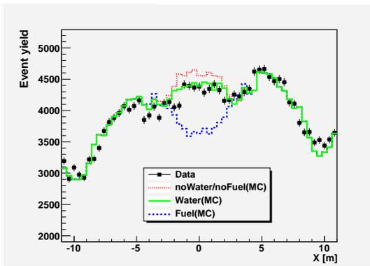
図 18: 核燃料を装填する位置での  $\mu$  粒子事象数分布のシミュレーションとの比較．水相当の物質の予想と測定値が一致し，測定期間中は燃料が装填されていないことを示した．
