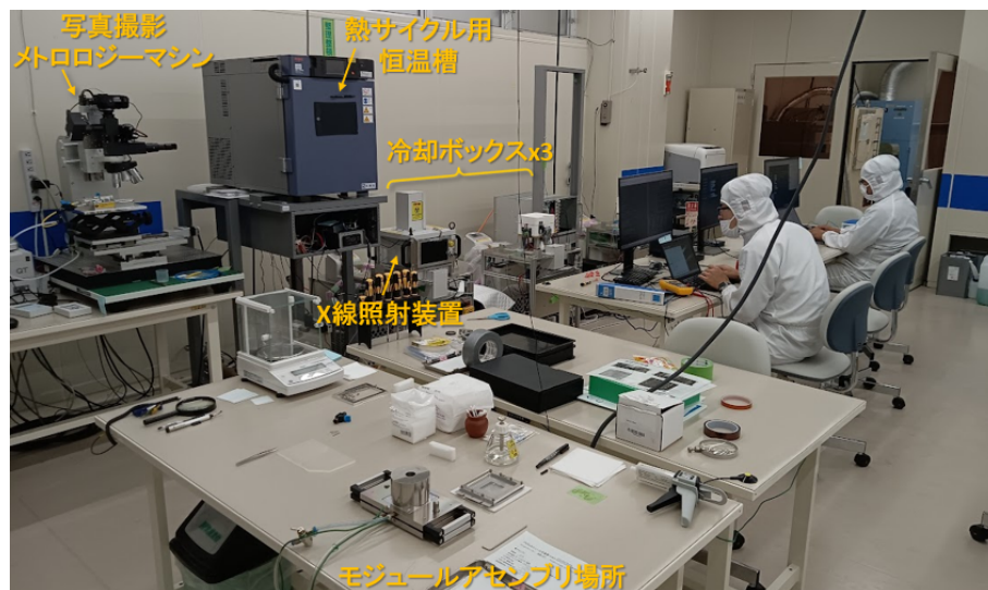
図 16: 量産開始時点でのハヤシレピック館山工場内 ITk ピクセルモジュール検査システムの様子。現在は、冷却ボックスを7台に、メトロロジーマシンを2台に増強し、1日最大7モジュールでの製作に備えてある。
